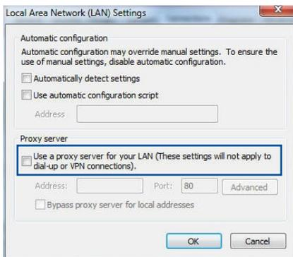
3. من شاشة إعدادات شبكة الاتصال المحلية (LAN)، قم بإلغاء اختيار Use a proxy server for your LAN (استخدام خادم وكيل لشبكة LAN الخاصة بك).
